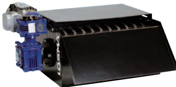
**La serie DEMAG è composta da 7 modelli standard e tramite dischi magnetici rotanti è in grado di depurare da 50 a 400 litri/minuto di olio emulsionato e da 25 a 200 litri/minuto di olio intero.**
